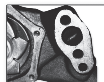
Barrenos descentrados de asiento de monoblock
