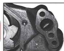
Barrenos concéntricos de asiento de monoblock
