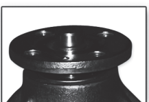
Correcta oscilación de la maza, 0.002"
