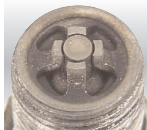
Calaminage Cubiertas de carbón
