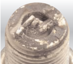
Dépôts résiduels d'huile Depósitos de cenizas aceitosas
